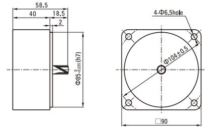
■ 电容器外形尺寸 Formal Dimension Of Capacitor
